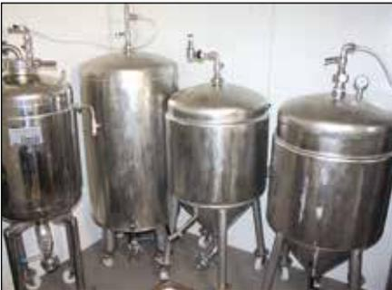
von Hellem, Weizen und Dunklem Bier. Nach dieser Offengärung wird es in die zylinderkonischen Gärtanks abgezogen. Davon stehen bis zu 6 Stück je ca. 2 hl zur Verfügung. Hier reift das Bier zwischen 3 und 6 Wochen, abhängig von der Biersorte, bis es zum Ausschank kommt. Anschließend wird das
