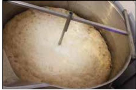
Der Ausstoß pro Sud beträgt 70 ltr., d.h. eine Tagesproduktion von ca. 2 hl Würze. Anschließend kommt die Würze zur offenen Vergärung in die offenen Gärbottiche.
